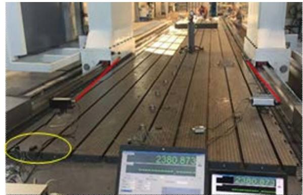
Fig.9 Misura di precisione di posizionamento di una macchina gantry effettuata con due laser contemporaneamente. I sensori di temperatura, evidenziati in giallo, sono su piano di lavoro.
