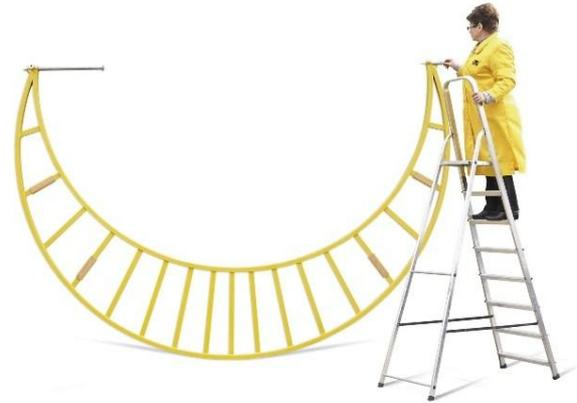
Fig.2 Calibro da officina di grande dimensione in acciaio, che si dilata come il pezzo, se il pezzo è d'acciaio.
