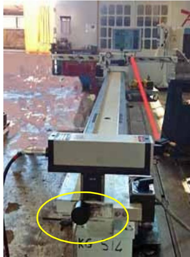
Fig. 11 Calibrazione laser di una macchina di misura a due dimensioni, utilizzata per le turbine, in officina. Il trasduttore di temperatura evidenziato in giallo sul corpo macchina che coincide con il trasduttore.
